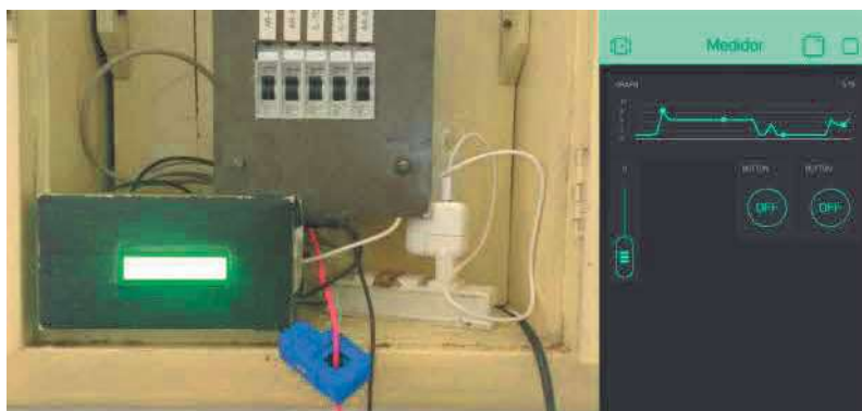
Figure 2. Módulo medidor e o print da leitura feita no aplicativo em tempo real
