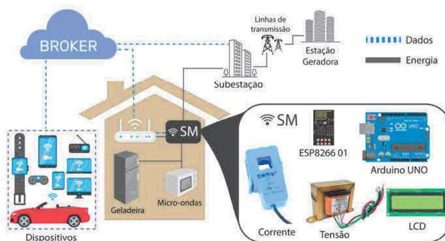
Figure 1. Arquitetura da automação realizada
