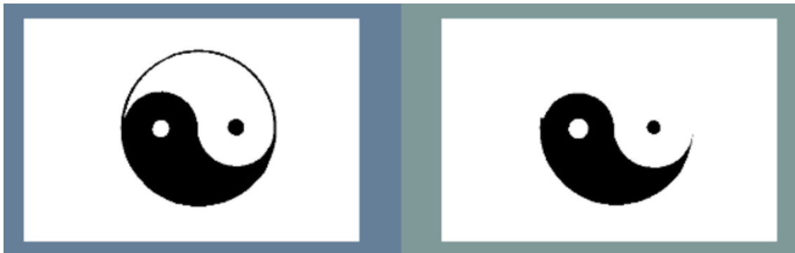
Figura 4.12. Exemplo de imagem de entrada e de saída com o operador de dilatação.
