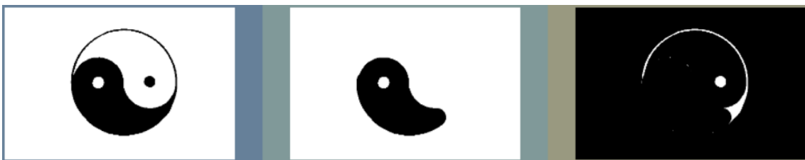
Figura 4.16. Exemplo de imagem de entrada e de saída com o operador de Fechamento. 1) original. (2) fechamento binário com radius = 20. (3) fechamento binário original.
