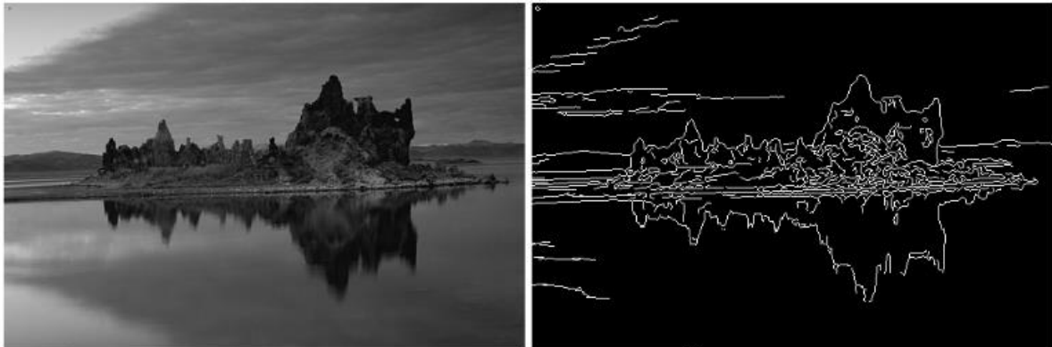
Figura 4.8. Entrada e saída com o esquema de detecção de bordas proposto por Canny (1986). Fonte: Adaptado de [LOURENÇO, 2011]
