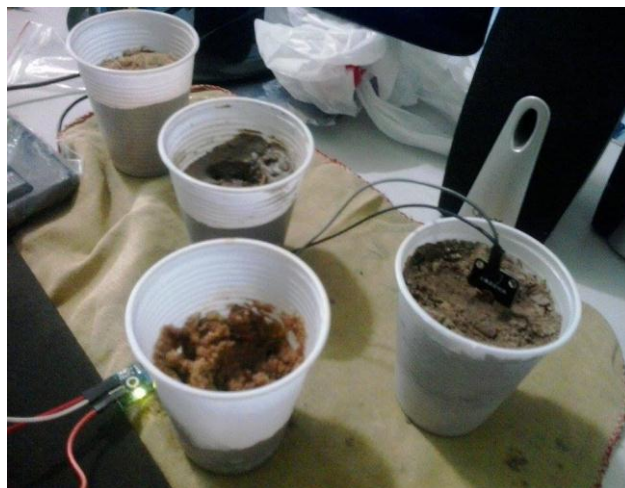
Figura 8: Calibragem do sensor de umidade do solo em diversas amostras de solo.
